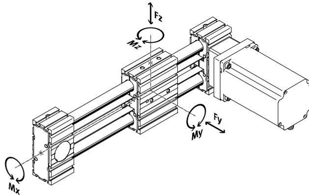
Wirken gleichzeitig mehrere der unten genannten Kräfte und Momente auf die Achse ein, muss neben den aufgeführten Maximalbelastungen folgende Gleichung erfüllt werden:
