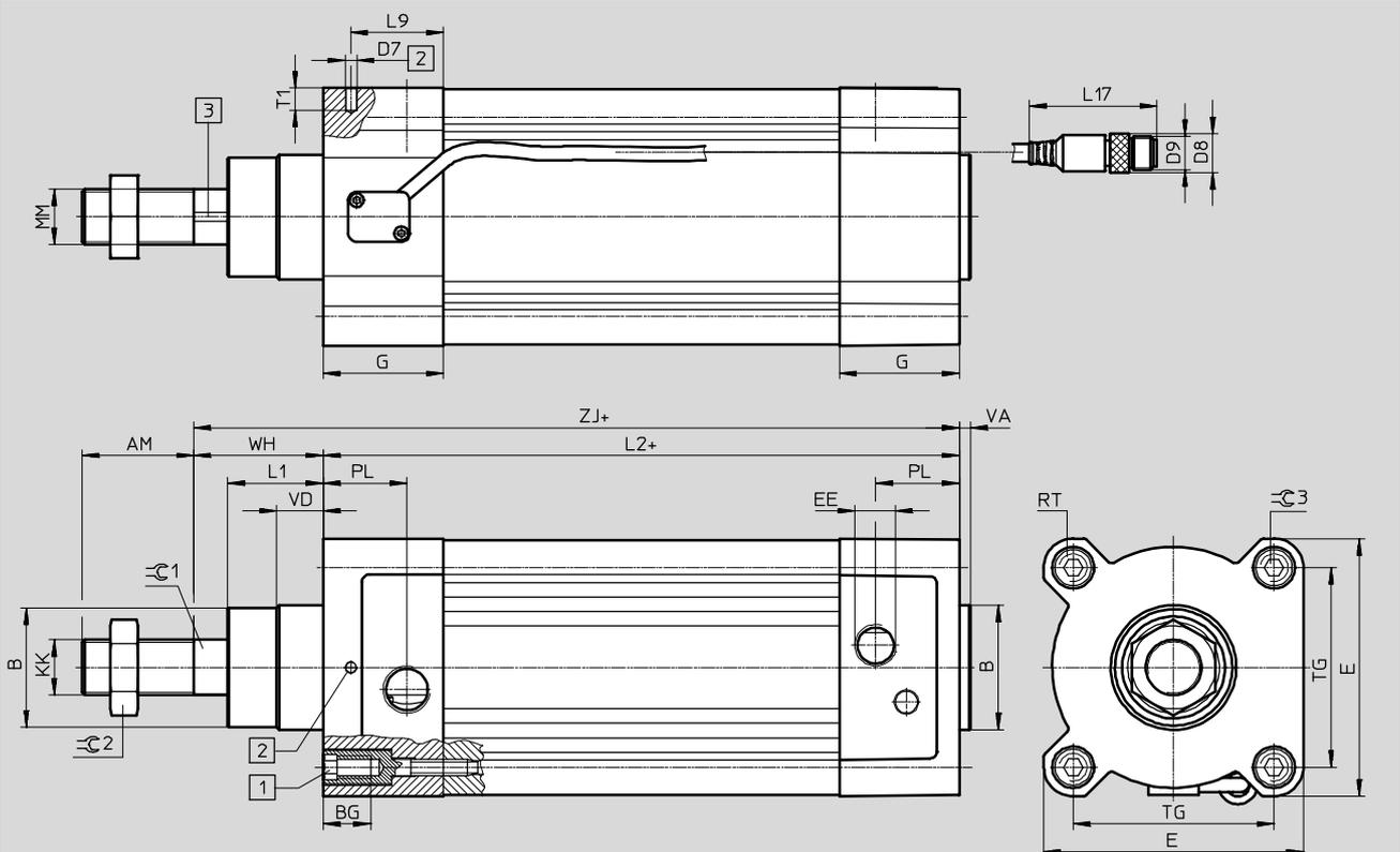
1 Innensechskantschraube mit Innengewinde für Befestigungselemente
