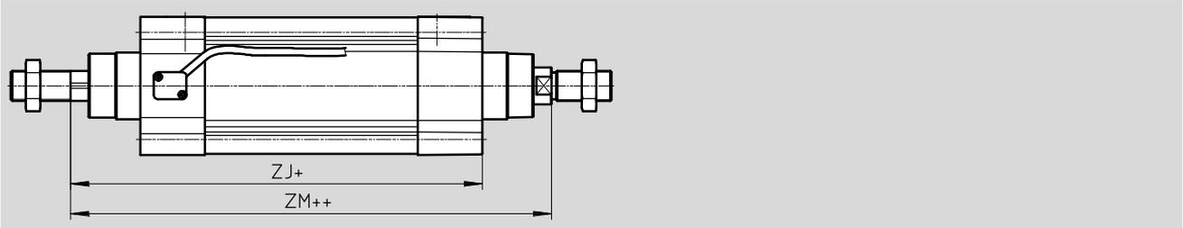
DDPC-...-CT – durchgehende Kolbenstange mit Feststelleinheit
