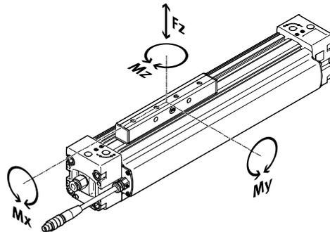
Wirken gleichzeitig mehrere der unten genannten Kräfte und Momente auf den Antrieb, müssen neben den ausgeführten Maximalbelastungen folgende Gleichung erfüllt werden:
