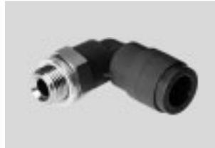
Racor rápido roscado pirorretardante para la utilización en zonas con peligro de incendio, por ejemplo en equipos de soldadura en la industria automovilística o en el sector de la construcción. Para aplicaciones neumáticas con temperaturas de hasta 60 °C y con presiones de hasta 10 bar. Diámetros exteriores de los tubos flexibles de 4, 6, 8, 10 y 12 mm con rosca de conexión R $\frac{1}{8}$  ... R $\frac{1}{2}$  y G $\frac{1}{8}$  ... G $\frac{1}{2}$ .
