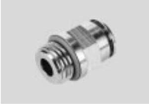
Racor metálico de latón, niquelado químico. Gran resistencia a la corrosión CRC3 y a sustancias químicas; certificación para la industria alimentaria y del envasado. Para aplicaciones neumáticas con temperaturas de hasta 150 °C y con presiones de hasta 20 bar. Diámetros exteriores de los tubos flexibles de 4, 6, 8, 10 y 12 y 14 mm con rosca de conexión M5, M7 y G $\frac{1}{8}$  ... G $\frac{1}{2}$ .
