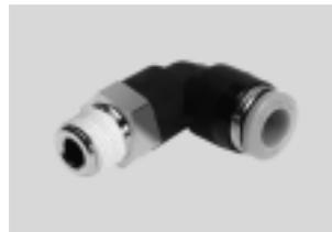
Racores rápidos roscados para funciones neumáticas básicas con temperaturas de hasta 60 °C y con presiones de hasta 10 bar. Diámetros exteriores de los tubos flexibles de 4, 6, 8, 10, 12 y 16 mm con rosca de conexión de M5 y R $\frac{1}{8}$  ... R $\frac{1}{2}$ .
