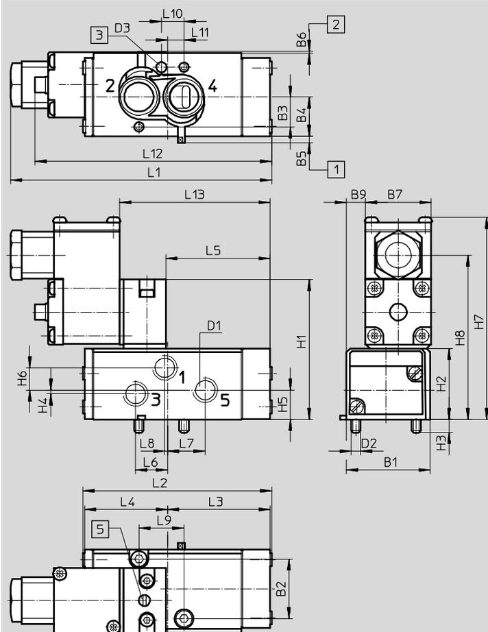
1 Placa obturadora en función de válvula de 5/2 vías
