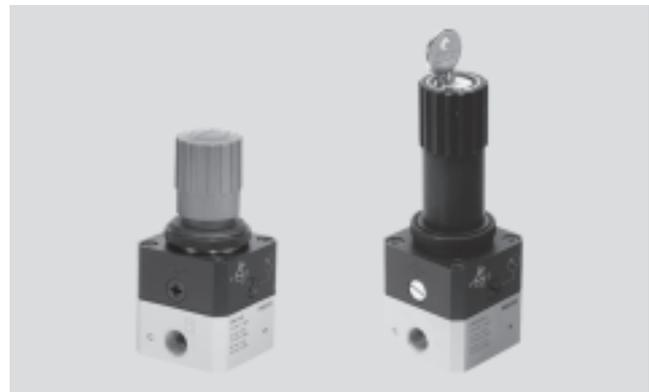
El regulador de precisión permite regular la presión de funcionamiento (lado secundario) mediante una membrana que actúa sobre el asiento principal, con lo que se consigue una característica de regulación mejor.
