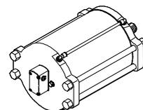
DFPI con sistema de medición de recorrido integrado, con conexiones neumáticas y eléctricas protegidas
