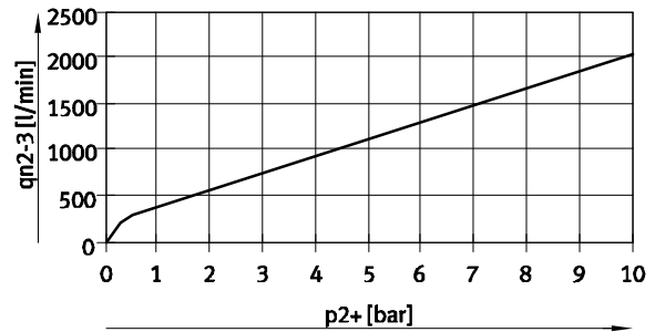
Durchfluss q_{n2-3} von 2 → 3 in Abhängigkeit vom Ausgangsdruck p_2 VPPX-8F-...-0L10H-... (10 bar)
