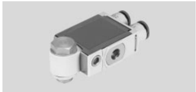
Beim Drossel-Rückschlagventil VFOF-LE-BAH handelt es sich um ein Ventil mit einer Funktionskombination aus Abluft-Drossel-Rückschlagfunktion und entsperbarer Rückschlagfunktion mit manueller Entlüftungsfunktion.
