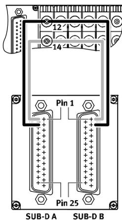
Das Beispiel zeigt die Pin-Belegung Code V12. Bei dieser sind die Ventilsolen in aufsteigender Reihenfolge der Ventile so verschaltet, dass Ventilsolen 14 den niederwertigen Pin und Ventilsolen 12 den nächstfolgenden Pin jeweils beider Sub-D-Anschlüsse belegt:
