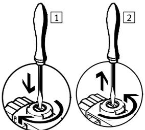
1 Stößel der Handhilfsbetätigung mit einem Schraubendreher hineindrücken bis das Ventil schaltet und anschließend im Uhrzeigersinn um 90° bis zum Anschlag drehen. Das Ventil bleibt in Schaltstellung.
