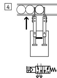
Durch den Sperrschieber kann Stößel A erst einfahren, wenn Stößel B vollständig ausgefahren ist.
