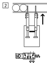
Durch den Sperrschieber kann Stößel B erst einfahren, wenn Stößel A vollständig ausgefahren ist.
