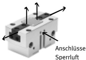
Bei angeschlossener Sperrluft (max. 0,5 bar) strömt an den Greifbacken Druckluft vorbei. Dadurch wird verhindert, dass z. B. Staub in die Greifbackenführung eindringen kann.
