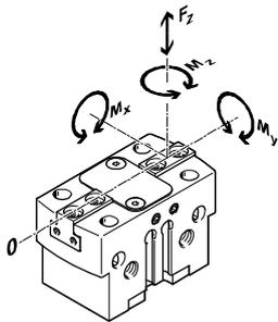
Die angegebenen zulässigen Kräfte und Momente beziehen sich auf einen Greifbacken. Sie beinhalten den Hebelarm, zusätzliche Gewichtskräfte durch das Werkstück bzw. durch externe Greiffinger und auftretende Be-
