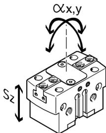
Bedingt durch die Gleitführung ist bei den Greifern ein Spiel zwischen den Greifbacken und dem Gehäuse gegeben. Die in der Tabelle eingetragenen Werte für das Spiel wurden nach der klassischen Toleranzadditionsmethode berechnet.
