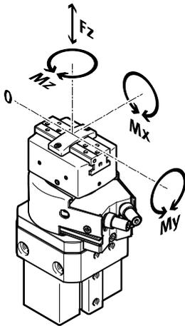
Die angegebenen zulässigen Kräfte und Momente beziehen sich auf einen Greifbacken. Die angegebenen Werte beinhalten den Hebelarm, zusätzliche Gewichtskräfte durch das Werkstück bzw. durch externe Greiffinger und auftretende Beschleunigungskräfte während der Bewegung.
