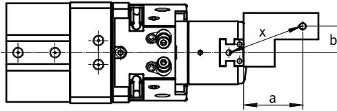
Mit dem errechneten Wert  $x$  kann aus den Diagrammen (→ ab 10) die Greifkraft  $F_H$  herausgelesen werden.
