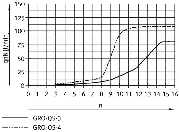
**Normaldurchfluss  $q_n$  bei 6 bar  $\rightarrow$  0 bar
