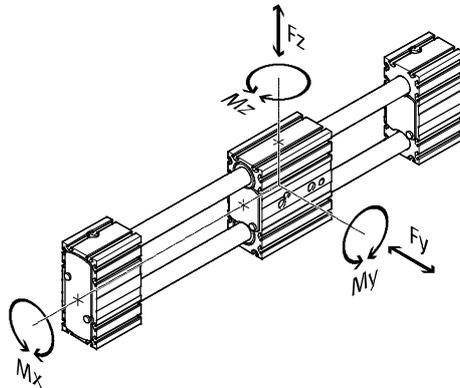
Wirken gleichzeitig mehrere der unten genannten Kräfte und Momente auf die Achse ein, muss neben den aufgeführten Maximalbelastungen folgende Gleichung erfüllt werden:
