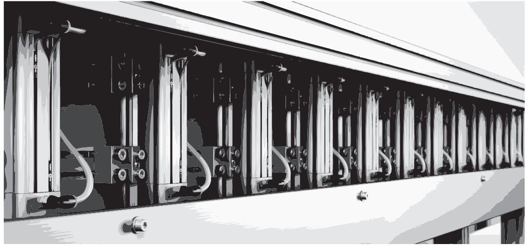
DSBC-PPS 설치예시: DSBC는 다수의 실린더가 동기로 작동 되거나 접근이 어려운 곳에서도 항상 일관성있고 최적으로 조절 됩니다.
