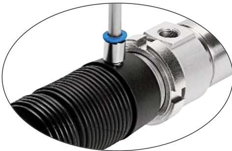
ジャバラキットDADBIには呼吸用ポートがあります。不適当な媒体を内部に吸い込むのを防止するために呼吸ポートに配管をし、離れた場所で排出させることができます。この場合、配管するチューブの長さによりシリンダの使用速度を制限します。下グラフは推奨継手を使用した時の配管長さL[m]における各シリンダサイズの許容速度v[mm/s]を表したものです。
