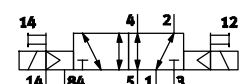
B52: Válvula biestable de 5/2 vías con alimentación externa del aire de pilotaje
