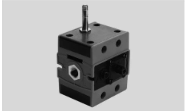
Válvula de cierre, accionada eléctricamente, para generación progresiva de la presión en instalaciones neumáticas. De este modo se facilita el arranque de los sistemas neumáticos. Una cantidad reducida de aire comprimido pasa a través de una válvula de estrangulación. La presión de salida se genera lentamente. Así, los cilindros y demás unidades conectadas a la red neumática alcanzan su posición inicial lentamente. Una vez que la
