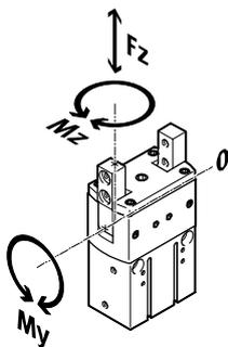
Las fuerzas y momentos admisibles se refieren a un dedo. Los valores indicados incluyen la fuerza de palanca, las fuerzas debido al peso de la pieza u ocasionadas por dedos externos y, además, las fuerzas ocasionadas por la aceleración durante la ejecución del movimiento. Al efectuar el cálculo de los momentos debe tenerse en cuenta el punto 0 del sistema de coordenadas (guiado de los dedos).
