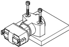
Mediante taladros, tornillos y tuercas de fijación
