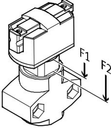
Fuerza teórica de accionamiento del compensador de carrera en la variante con compensación de carrera.
