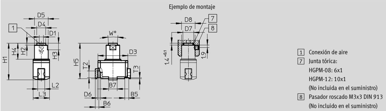
Con fijación por brida: HGPM-...-E...-G9
