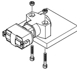
Fijación con brida, tornillos y pasadores cilíndricos
