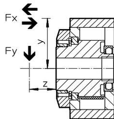
$$\frac{F_{y(z)}}{F_{y,max(z)}} + \frac{F_{x,comp.(v)}}{F_{x,comp.,max.(v)}} + \frac{F_{x,trac.(v)}}{F_{x,trac.,max.(v)}} \leq 1$$
