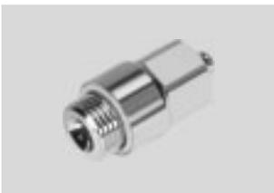
Racor de acero inoxidable para la aplicación en áreas expuestas a una limpieza intensiva. Máxima clase de resistencia a la corrosión CRC4. Para aplicaciones neumáticas con un margen de temperaturas de hasta 120 °C y con un margen de presiones de hasta 12 bar. Diámetro ext. del tubo flexible de 6 mm con rosca de conexión G $\frac{1}{8}$ .
