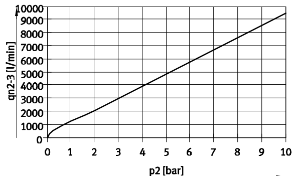
Durchfluss q_n von 2 \rightarrow 3 in Abhängigkeit vom Ausgangsdruck p_2 VPPX-12L-...-0L10H-... (10 bar)
