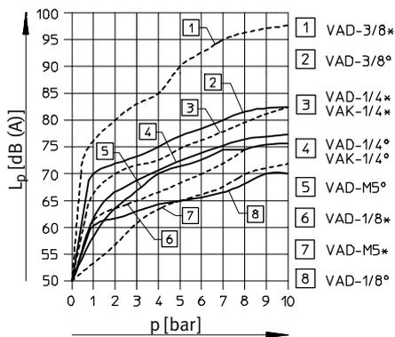
\* = ohne Schalldämpfer; ° = mit Schalldämpfer
