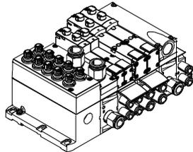
Die Signalansteuerung von der Steuerung zur Ventilinsel erfolgt über Einzelanschlusskabel.
