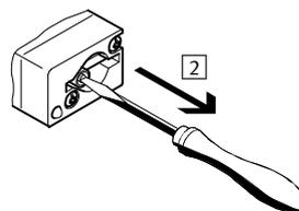
2 Stift oder Schraubendreher entfernen. Federkraft drückt den Stößel der Handhilfsbetätigung zurück. Ventil kehrt in Grundstellung zurück (nicht bei bistabilem Ventil Code J, D).
