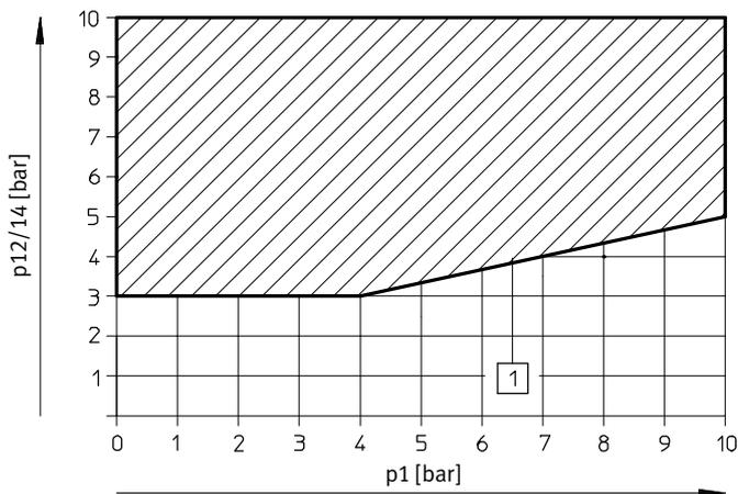
1 Arbeitsbereich für Ventile mit externer Steuerluftversorgung
