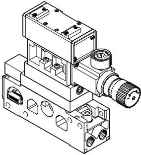
Auf jedem Ventilplatz ISO Größe 3 können zwischen Grundplatte (Verkettungsplatte) und Ventil weitere Baueinheiten eingefügt werden. Diese, mit
