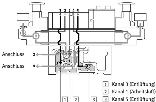
Dieser Druckregler regelt den Druck in den Kanälen 2 und 4 nachdem das Druckmedium durch das Ventil geströmt ist. Beim Entlüftungsvorgang wird im Ventil über den Druckregler von Kanal 2 nach Kanal 3 und von Kanal 4 nach Kanal 5 entlüftet.
