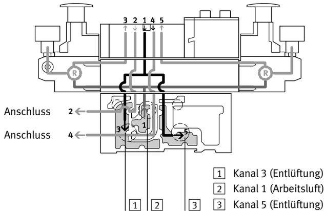
Bei diesem Druckregler wird die Arbeitsluft (Kanal 1) aufgesplittet und direkt auf beide Druckregler geleitet. Die jeweils geregelte Arbeitsluft steht in den Kanälen 3 und 5 am Ventil an. Das Ventil wird somit reversibel betrieben. Das heißt:
