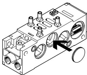
Unterschiedliche Versorgungsdrücke im Bereich der Ventile Baubreite 65 mm sind durch den Einbau von Verschluss-scheiben zwischen zwei Anschlussblöcken möglich. Dabei ist zu beachten,
