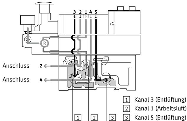
Dieser Druckregler regelt den Druck vor dem Ventil im Kanal 1. Dadurch haben die Kanäle 2 und 4 den gleichen geregelten Druck.
