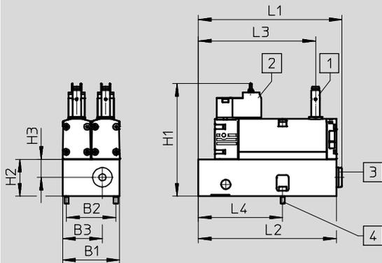
1 Näherungsschalter PNP, bzw. NPN, Größe M8x1, Steckeranschluss nach EN 61076-2-104
