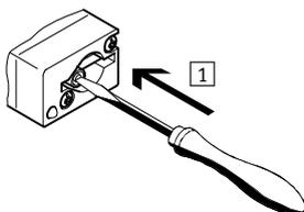
1 Stößel der Handhilfsbetätigung mit Stift oder Schraubendreher hineindrücken. Ventil ist in Schaltstellung.
