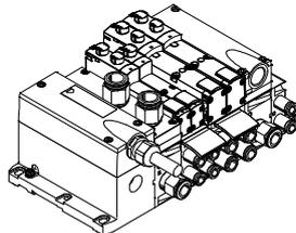
Die Signalansteuerung von der Steuerung zur Ventilinsel erfolgt über ein mehradriges vorkonfiguriertes Kabel oder selbstkonfigurierbaren Multipolanschluss (Zugfederklemme). Dadurch wird der Installationsaufwand erheblich reduziert.
