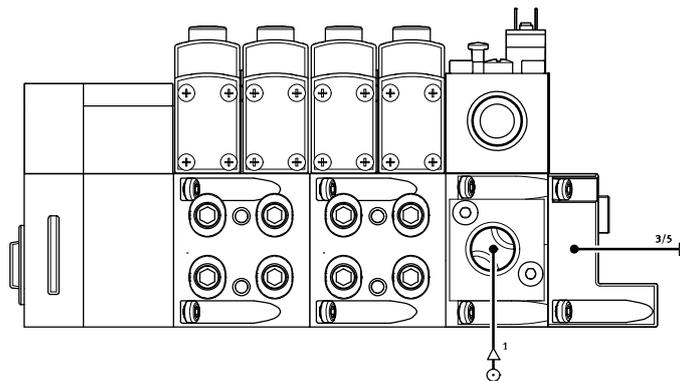
1) Bei dieser Konstellation ist eine rechte Endplatte mit Codierdeckel nicht möglich, da hierüber keine Abluft abgeführt werden kann
