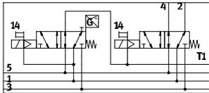
Ursprünglich wird die Funktion zum Abschalten der Steuerluft durch die Kombination der Zwischenplatte Typ VABF-S4-...-S mit dem monostabilen 5/2 Wege-Magnetventil Typ VSVA-B-M52-MZD-...-1T1L-APX-0,5 erzielt. Über die rechte Endplatte Typ VABE-S6-1 (Ident-Code XS, externe Steuerluft) wird der Ventilinsel keine Steuerluft zugeführt. Der Anschluss 14 auf der Endplatte ist verschlossen.
