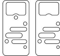
Dichtung für Steuerluftversorgung extern
