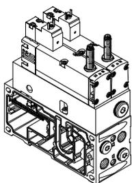
Die Ventile mit integrierter Kolbenstellungsabfrage auf Verkettungsplatte für Ventilinsel VTSA/VTSA-F müssen unabhängig von der Art der elektrischen Ansteuerung der Ventilinsel (Einzel-, Multipol- oder Feldbus-/Steuerblockanschluss) elektrisch versorgt werden.
