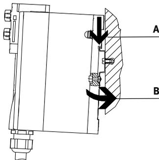
Die VTSA/VTSA-F Ventilinsel wird in die Hutschiene eingehängt (siehe Pfeil A).
