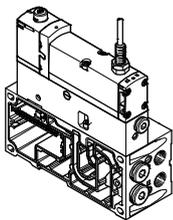
Das Steuerluft-Schaltventil ist eine Kombination aus einem 5/2 Wege-Magnetventil mit Schaltstellungsabfrage und der Zwischenplatte VABF-S4-...-S. Es ermöglicht das überprüfbare Ein- und Ausschalten (Sensorabfrage) der Steuerluftversorgung von
