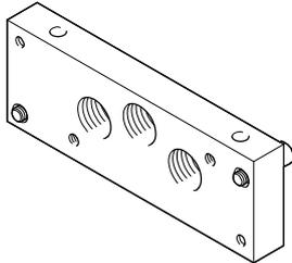
Die Adaption auf Baubreite 65 mm ISO Größe 3 wird über die rechte Endplatte und/oder die Adapterplatte VABA ... mit Druckluft versorgt.
