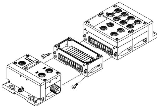
Die CPX-Module in Metallausführung werden durch eine Schrägverschraubung mechanisch miteinander verbunden. Das CPX-Terminal ist so jederzeit flexibel erweiterbar.
