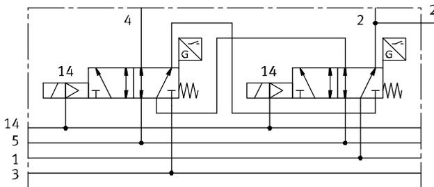
Beim Steuerblock mit Sicherheitsfunktion VOFA-B26-T52-... für die Ventilinsel werden zwei 5/2-Wege-Magnetventile, Baubreite 26 mm,
