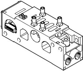
Die Adaption auf Baubreite 65 mm ISO Größe 3 basiert auf einem modularen System, bestehend aus Verkettungsplatten und Ventilen. Die Verkettungsplatten enthalten eine Kanaldichtung und eine elektrische Verkettung, sind miteinander verschraubt und bilden so das Trägersystem für die
