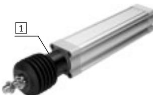
Der Faltenbalgbausatz ist ein leakage-freies System. Um das Ansaugen von unerwünschten Medien zu vermeiden, ist die Zuluft bzw. Abluft des Bausatzes über eine Druckausgleichsöffnung im Anbindungsteil **1** gefasst.
