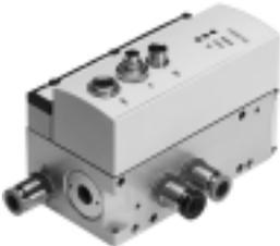
Das 5/3 Proportional-Wegeventil für Anwendungen mit Soft Stop und pneumatisch Positionieren. Voll digitalisiert – mit integrierten Drucksensoren, mit neuen Diagnosefunktionen. In den Baugrößen 4, 6, 8 und 10. Durchflussrate von 350, 700, 1400 und 2000 l/min.
