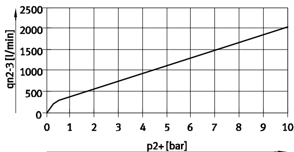
Průtok q_{n2} \rightarrow 3 v závislosti na výstupním tlaku p_2
