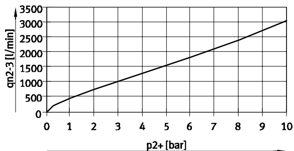
Průtok q_{n2} \rightarrow 3 v závislosti na výstupním tlaku p_2
