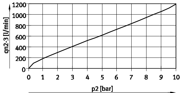
Průtok q_{n2} \rightarrow 3 v závislosti na výstupním tlaku p_2
