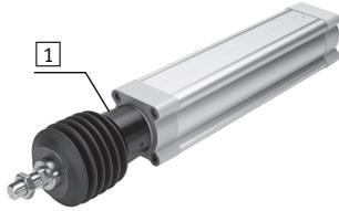
波纹管组件是一种无泄漏系统。为防止吸入异物，必须通过连接件 1 上的压力补偿孔进气和排气。
