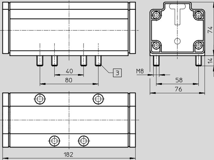
3 Viti di fissaggio antisfilamento
