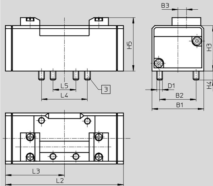
3 Viti di fissaggio antisfilamento
