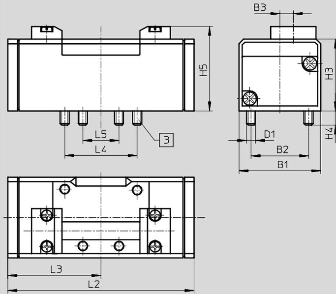
3 Viti di fissaggio antisfilamento
