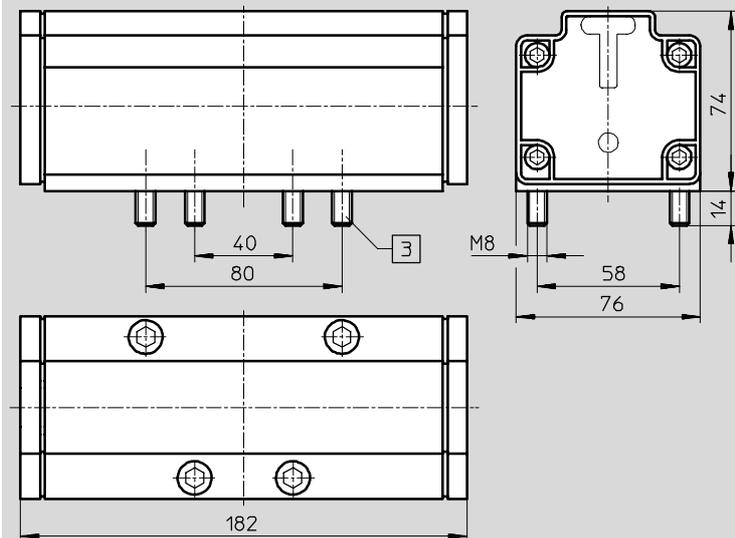
3 Viti di fissaggio antisifilamento
