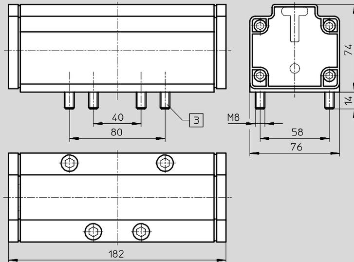
3 Viti di fissaggio antisifilamento
