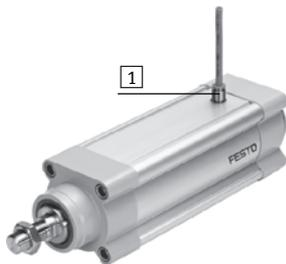
Le vérin électrique avec l'option IP65 est conforme aux spécifications selon IEC 60 529. Un orifice de compensation de pression **1** dans le tube de vérin produit un passage d'air entre l'intérieur du vérin et l'environnement. Cela permet d'éviter les dépression/surpressions à l'intérieur du vérin.
