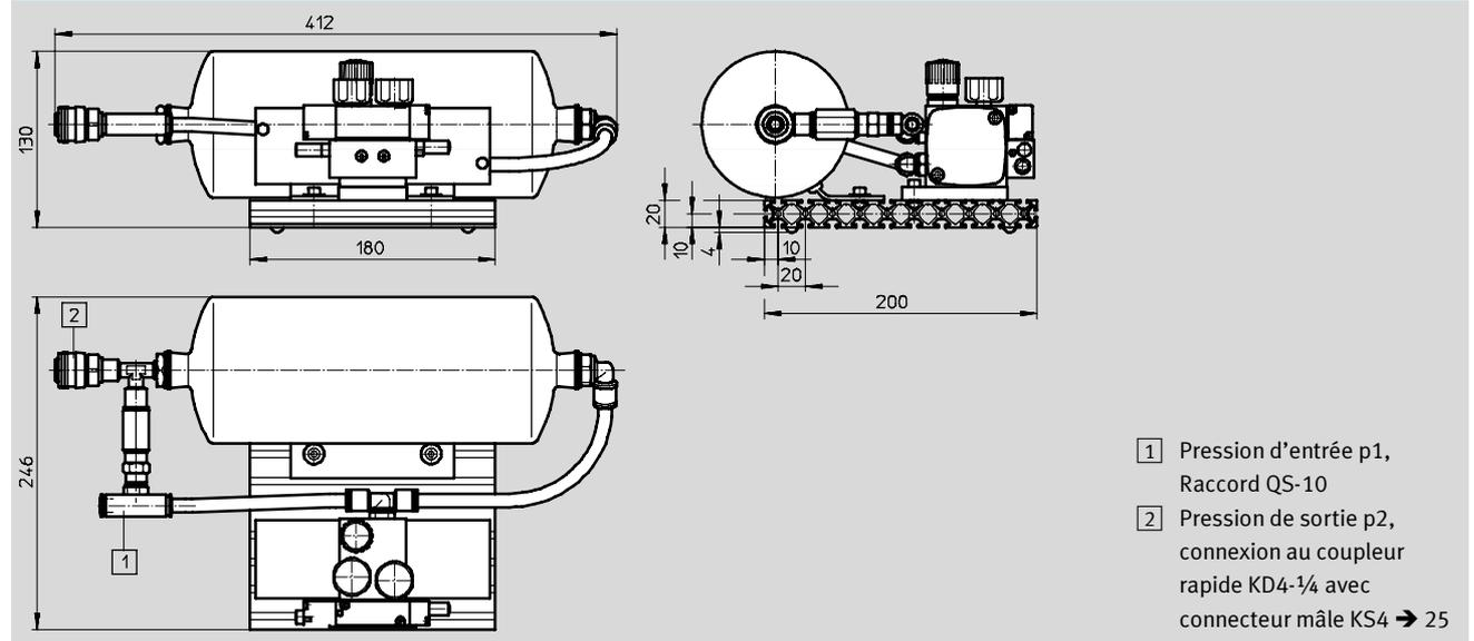
avec accumulateur pneumatique 5 l
