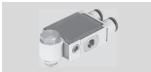
La válvula de estrangulación y antirretorno VFOF-LE-BAH es una válvula que combina la función de estrangulación de escape con antirretorno con la función de antirretorno desbloqueable y escape manual.
