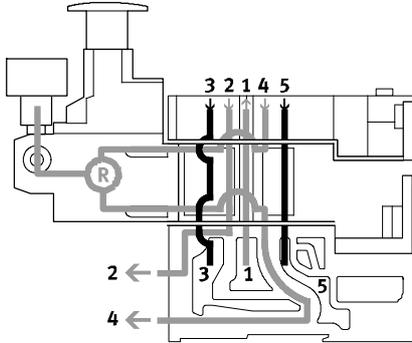
Este regulador de presión permite ajustar la presión en el canal 4 una vez que el fluido ha atravesado la válvula. Durante la operación de evacuación de aire, se produce el escape desde el canal 4 hacia el canal 5 a través del regulador de presión.
