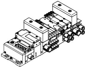
La transmisión de datos a un PLC está a cargo de un nodo de bus de campo. De esta manera, es posible obtener una solución de dimensiones compactas en su parte neumática y electrónica.
