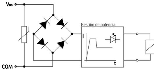
Cada bobina MPA tiene un circuito protector para supresión de arco voltaico y, además, tiene polaridad inconfundible. Además, todas las válvulas están equipadas adicionalmente con una reducción integrada de la corriente.
