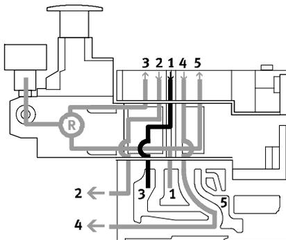
El regulador B reversible distribuye el aire de trabajo en el canal 1 y regula la presión delante de la válvula en el canal 3 (en el canal 5 se aplica la presión no regulada del canal 1). A continuación, el aire regulado se desvía hacia el canal 2. Ello significa que la válvula está funcionando en modalidad reversible.
