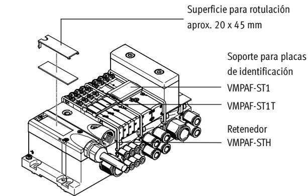
Para identificar las válvulas puede montarse en cada placa de alimentación un soporte de placas rotulables VMPAF-ST1 (n° de art. 546 228, código T en el código de pedido) o VMPAF-ST1T (n° de art. 544 422, con placas de identificación IBS-9x20). A modo de alternativa o adicionalmente pueden colocarse placas de
