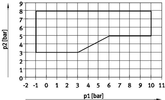
1 Margen de funcionamiento de válvulas con alimentación externa del aire de pilotaje
