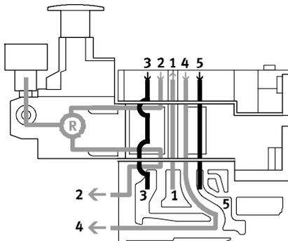
Este regulador de presión permite ajustar la presión en el canal 2 una vez que el fluido ha atravesado la válvula. Durante la operación de evacuación de aire, se produce el escape desde el canal 2 hacia el canal 3 a través del regulador de presión.
