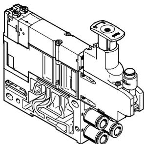
En cada posición de válvula pueden intercalarse otros módulos funcionales entre la placa de base y la válvula.
