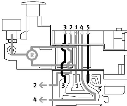
Este regulador regula la presión en el canal 1, delante de la válvula. De esta manera, los canales 2 y 4 tienen la misma presión regulada.
