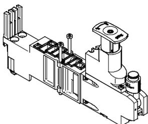
Para controlar la fuerza de los actuadores es posible montar un regulador entre la placa base y la válvula correspondiente.
