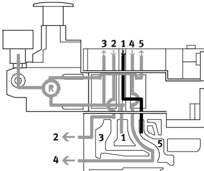
El regulador A reversible distribuye el aire de trabajo en el canal 1 y regula la presión delante de la válvula en el canal 5 (en el canal 3 se aplica la presión no regulada del canal 1). A continuación, el aire regulado se desvía hacia el canal 4. Ello significa que la válvula está funcionando en modalidad reversible.
