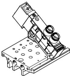
• Gracias a la utilización de las mismas válvulas básicas para el uso individual o en baterías, es posible efectuar sustituciones de modo rápido y sencillo o, también, utilizar los componentes varias veces.
