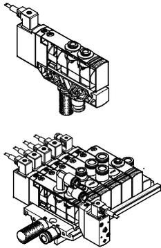
Conexión posible independientemente del control y con conexión flexible mediante cables preconfigurados. Se ofrecen dos tipos de válvulas: válvulas con conexiones roscadas y válvulas con semiconexiones roscadas para perfiles distribuidores o para placas base. En caso de conexión individual, puede elegirse entre 2 ... 20 bobinas (repartidas entre 2 ... 10 posiciones de válvulas).
