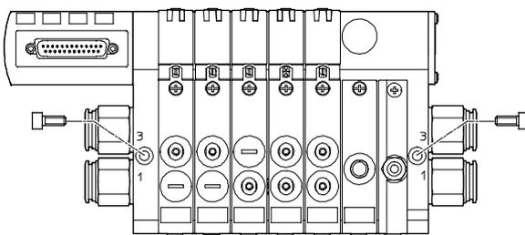
El terminal de válvulas VTUB se fija a la superficie (pared) mediante dos tornillos M5.
