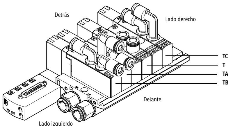
Posiciones de las conexiones de la válvula:
