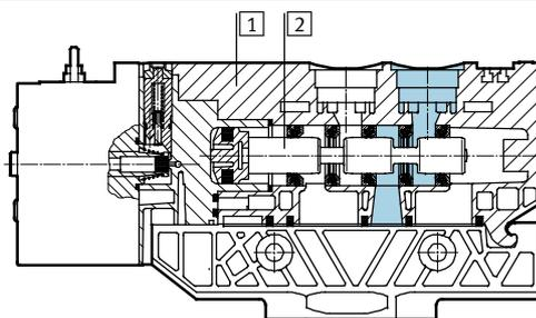
Esquema de funcionamiento: válvula biestable
