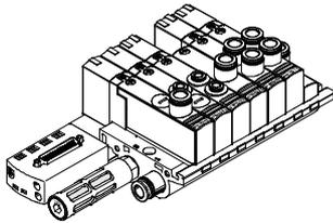
La señal entre la unidad de mando y el terminal de válvulas es transmitida a través de un cable multifilar preconfigurado. De esta manera, la instalación resulta mucho más sencilla.
