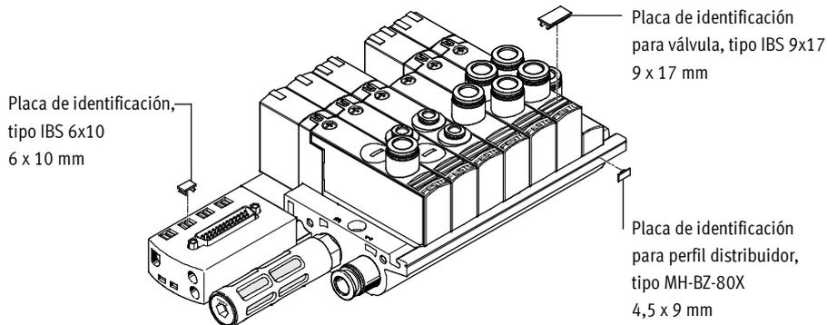
Para identificar las válvulas y los perfiles distribuidores pueden montarse placas de identificación.
