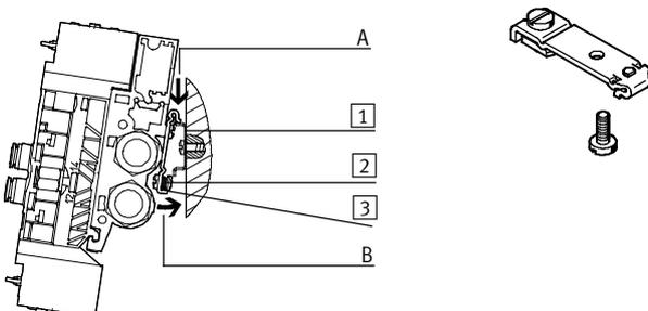
El terminal de válvulas VTUB se cuelga en el perfil DIN (ver flecha A). A continuación se presiona el terminal de válvulas VTUB y se fija mediante la pieza de bloqueo (ver flecha B).
