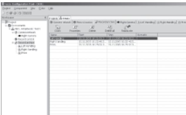
Una vez efectuados los ajustes, la cámara puede empezar a funcionar. Puede elegirse si la cámara debe esperar una señal externa, si debe empezar a captar imágenes inmediatamente después de recibir dicha señal o si debe guardar las imágenes en una memoria intermedia y enviarlas al PC a través de Ethernet. Después del inicio de la captación de imágenes estando activada la modali-
