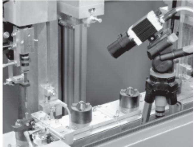
Montaje estacionario de la cámara compacta para aumentar la disponibilidad de las máquinas automatizadas.
