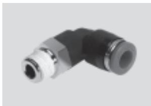
Gran selección de racores rápidos roscados para aplicaciones neumáticas con temperaturas de hasta 80 °C y con presiones de hasta 14 bar. Diámetros exteriores de los tubos flexibles de 4, 6, 8, 10, 12 y 16 mm con rosca de conexión de R $\frac{1}{8}$  ... R $\frac{1}{2}$  y G $\frac{1}{8}$  ... G $\frac{1}{2}$ .
