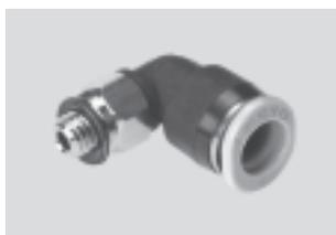
Racor rápido roscado de pequeñas dimensiones para lograr el más alto grado de integración en espacios reducidos. Para aplicaciones neumáticas básicas con temperaturas de hasta 60 °C y con presiones de hasta 10 bar. Diámetros exteriores del tubo flexible de 3, 4 y 6 mm con rosca de conexión M3, M5, M7 y R $\frac{1}{8}$ .
