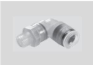
Racor de polipropileno, ideal para aplicaciones bajo condiciones del entorno extremas. Para aplicaciones neumáticas con temperaturas de hasta 60 °C y con presiones de hasta 10 bar. Diámetros exteriores de los tubos flexibles de 4, 6, 8, 10 y 12 mm con rosca de conexión R $\frac{1}{8}$  ... R $\frac{1}{2}$ .
