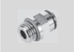
Racor metálico de latón, niquelado químico. Gran resistencia a la corrosión CRC3 y a sustancias químicas; certificación para la industria alimentaria y del envasado. Para aplicaciones neumáticas con temperaturas de hasta 150 °C y con presiones de hasta 16 bar. Diámetros exteriores de los tubos flexibles de 4, 6, 8, 10 y 12 y 14 mm con rosca de conexión M5, M7 y G $\frac{1}{8}$  ... G $\frac{1}{2}$ .
