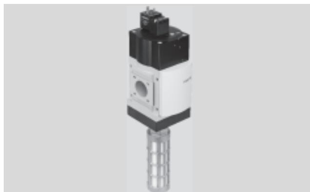
Válvula electro neumática de arranque progresivo y escape para aplicar lentamente aire comprimido y obtener un escape rápido del aire (canal único).
