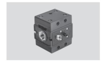
Válvula de cierre, accionada neumáticamente, para generación progresiva de la presión en instalaciones neumáticas. De este modo se facilita el arranque de los sistemas neumáticos. Una cantidad reducida de aire comprimido pasa a través de una válvula de estrangulación. La presión de salida se genera lentamente. Así, los cilindros y demás unidades conectadas a
