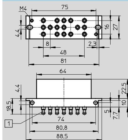
1 Boquilla enchufable para tubos flexibles con diámetro interior de 3 mm
