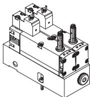
Beim Steuerblock, Ausführung für Ventilinsel VTSA/VTSA-F, werden die Ventile getrennt von der Ventilinsel über elektrischen Einzelanschluss angesteuert. Der pneumatische Anschluss erfolgt über die Ventilinsel VTSA/VTSA-F.
