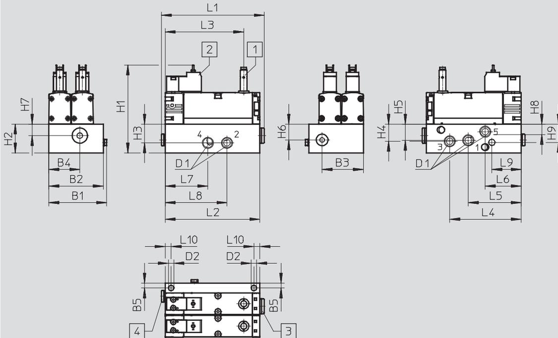
1 Näherungsschalter PNP, bzw. NPN, Größe M8x1, Steckeranschluss nach EN 61076-2-104
