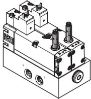
Bei der dezentralen Einzelanschlussvariante erfolgt der elektrische Anschluss des Steuerblocks als Einzelanschluss nach ISO 15407-1. Der pneumatische Anschluss ist ebenfalls als Einzelanschluss ausgeführt. Bei dieser Variante, werden die zwei 5/2 Wege-Magnetventile mit der Einzelanschlussplatte pneumatisch zweikanalig verkettet.
