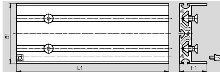
Die Länge L1 ist hubabhängig und muss bei der Bestellung angegeben werden (L<sub>max.</sub> = 3 m).
