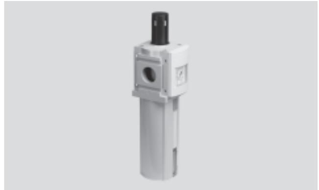
In diesem Gerät sind Filter und Druckregelventil zu einer Einheit zusammengefasst. Der Sinterfilter mit Wasserabscheider befreit die Druckluft von Schmutz, Rohrsinter, Rost und Kondenswasser.
