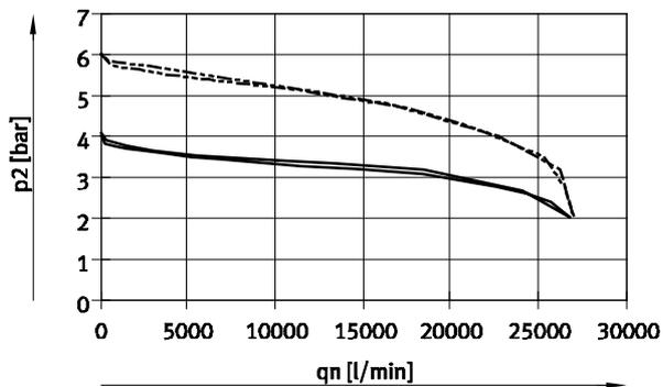
Filterfeinheit 40  $\mu\text{m}$ , Pneumatischer Anschluss NPT1-11 $\frac{1}{2}$
