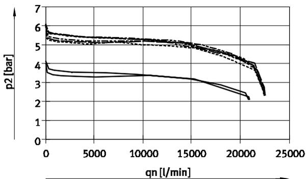
Filterfeinheit 40  $\mu\text{m}$ , Pneumatischer Anschluss NPT $\frac{3}{4}$ -14
