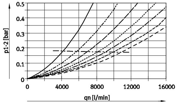
Filterfeinheit  $1\ \mu\text{m}$
