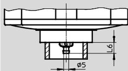
Stecknippel für Kunststoffschlauch PCN-4
