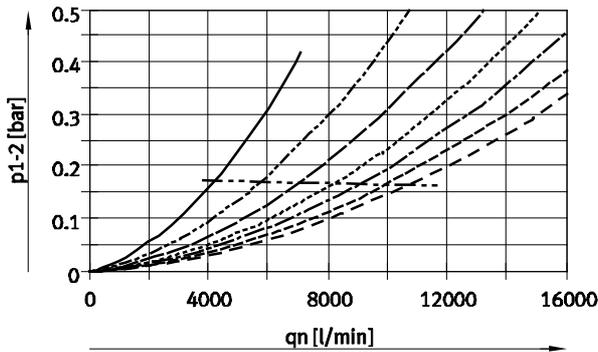
Filterfeinheit  $1\ \mu\text{m}$
