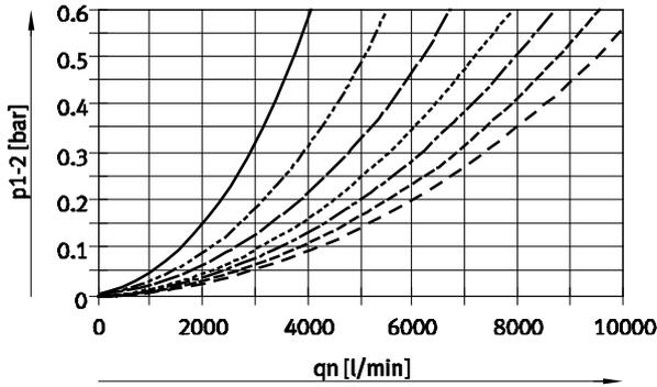
Filterfeinheit  $1\ \mu\text{m}$
