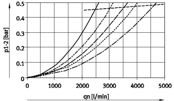
MS6-LFM-1/2-...-HF, Filterfeinheit 0,01 µm
