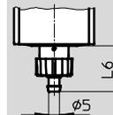
Stecknippel für Kunststoffschlauch PCN-4
