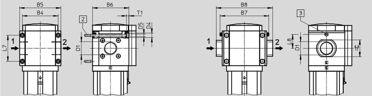
2 Befestigungsschraube M6xmin.90 nach DIN 912 (nicht im Lieferumfang enthalten) zur Wandmontage ohne Befestigungswinkel
