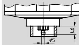
Stecknippel für Kunststoffschlauch PCN-4
