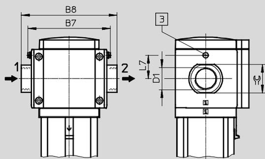
2 Befestigungsschraube M6xmin.90 nach DIN 912 (nicht im Lieferumfang enthalten) zur Wandmontage ohne Befestigungswinkel
