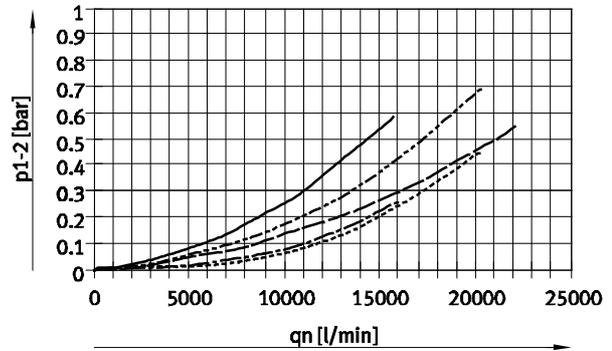
Filterfeinheit 0,01  $\mu\text{m}$
