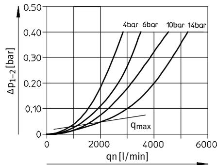
**Normaldurchfluss  $q_n$  in Abhängigkeit vom Differenzdruck  $p_{1-2}$**
