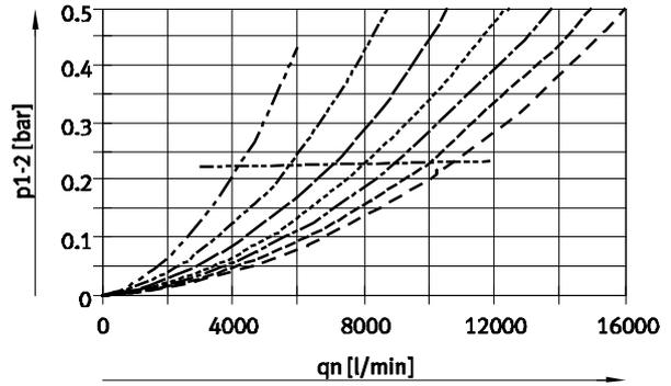
Filterfeinheit  $1\ \mu\text{m}$
