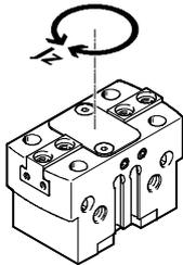
Massenträgheitsmoment des Parallelgreifers bezogen auf die Mittelachse, ohne externe Greiffinger, im unbelasteten Bauzustand.
