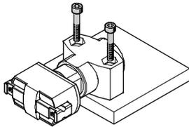
Mit Durchgangsbohrung, Schrauben und Befestigungsmutter
