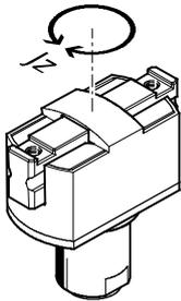
Massenträgheitsmoment [ $\text{kgm}^2 \times 10^{-4}$ ] der Parallelgreifer bezogen auf die Mittelachse, ohne externe Greiffinger, im unbelasteten Bauzustand.
