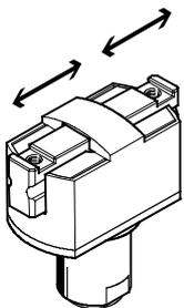
Die angegebenen Öffnungs- und Schließzeiten [ms] wurden bei Raumtemperatur, 6 bar Betriebsdruck und bei senkrecht eingebautem Greifer ohne zusätzliche Greiffinger gemessen. Durch den Anbau von externen Greiffingern wird die zu bewegende Masse erhöht. Dies bedeutet, daß sich zugleich die kinetische Energie er-
