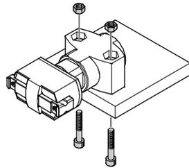
Mit Flanschbefestigung, Schrauben und Zylinderstifte
