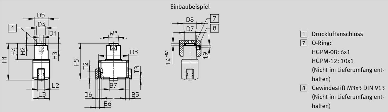
Mit Flanschbefestigung – HGPM-...-E...-G9
