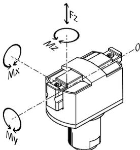
Die angegebenen zulässigen Kräfte und Momente beziehen sich auf einen Greifbacken. Die angegebenen Werte beinhalten den Hebelarm, zusätzliche Ge-
