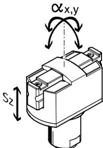
Bedingt durch die Gleitführung ist bei den Parallelgreifern ein Spiel zwischen den Greifbacken und dem Führungselement gegeben. Die in der Tabelle eingetragenen
