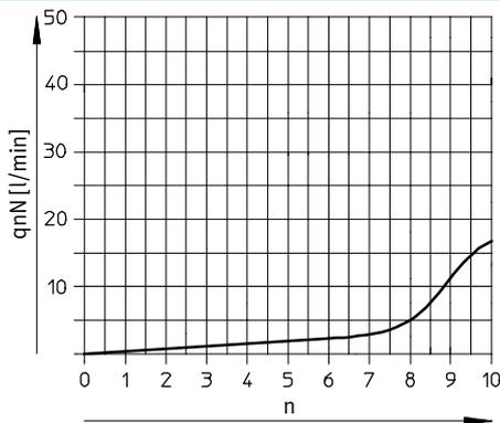
Normaldurchfluss  $q_n$  bei 6  $\rightarrow$  0 bar
