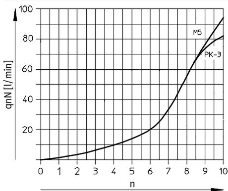
**Normaldurchfluss qn bei 6 bar → 0 bar in Abhängigkeit der Spindelumdrehungen n**
