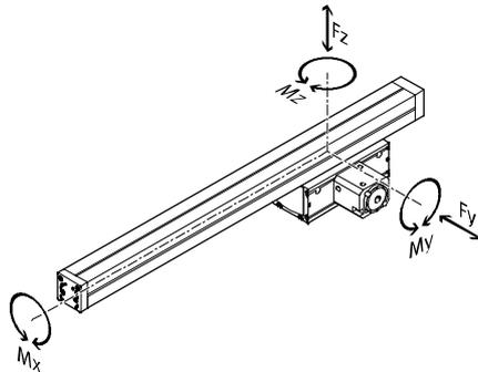
Wirken gleichzeitig mehrere der unten genannten Kräfte und Momente auf die Auslegerachse ein, müssen neben den aufgeführten Maximalbelastungen folgende Gleichung erfüllt werden:
