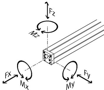
Wirken gleichzeitig mehrere der unten genannten Kräfte und Momente auf die Auslegerachse ein, müssen neben den aufgeführten Maximalbelastungen folgende Gleichung erfüllt werden:
